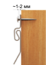
Монтаж панелей без антиураганного замка (панели серии STANDARD). "Шуршит" при сильном ветре.
