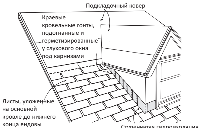
Рис. 6-4: Гидроизоляция фронтальной/боковой стены.
