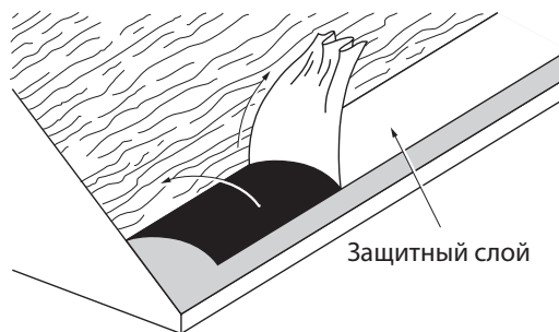
Рис. 5-6. Укладка методом «задира и прижима».
