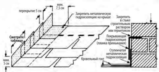
Рис. 6-2: Ступенчатая гидроизоляция боковой стены (см. также Рис. 6-10)
