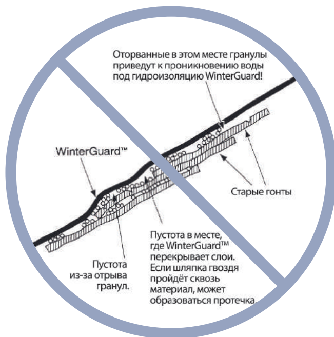
Рис. 5-4. Проблемы, возникающие при укладке WinterGuard на крышу.
