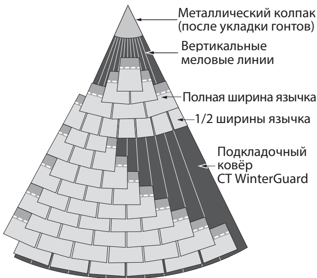
Рис. 9-6. Укладка гонта на округлённую часть крыши.
