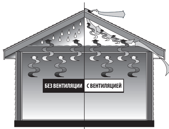
Рис. 7-8. Вентиляция чердачного помещения за счёт теплового эффекта.
