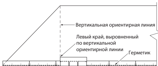
Рис. 9-2. Укладка первого гонта первого ряда таким образом, чтобы его левый край был выровнен по вертикальной ориентирной линии.
