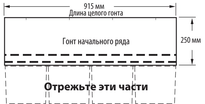
Рис. 14-5. Изготовьте гонты начального ряда, отрезав 20,3 см язычки.
