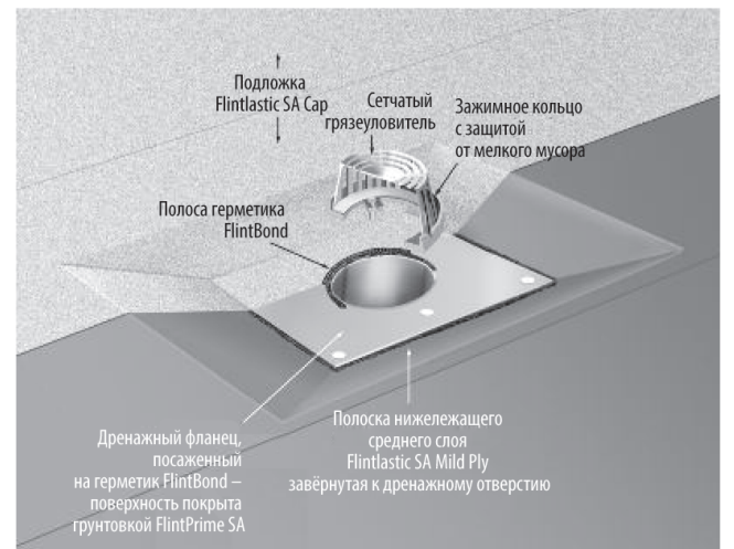
Рис. 5-36. Дренаж в трёхслойной системе.
