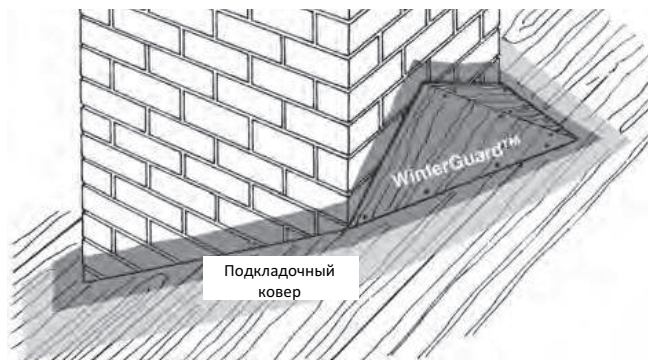
Рис. 6-8: Дымоход через настил крыши.
