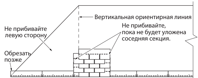
Рис. 9-5. Вертикальная секция гонта.
