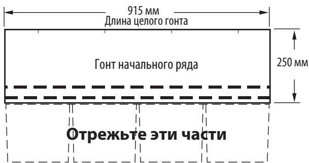
Рис. 14-10. Укладка гонтов начального ряда вдоль краёв ската.
