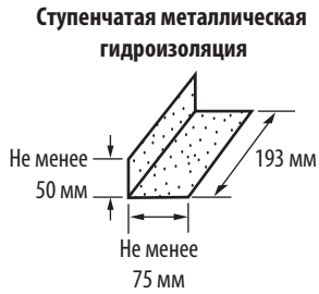
Рис. 12-10. Минимальные размеры ступенчато гидроизоляции.
