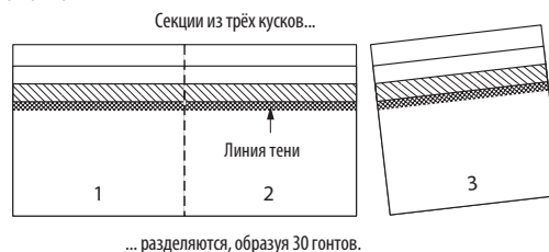
Рис. 15-19. Разделите, чтобы получить 3 покрывающих гонта.
