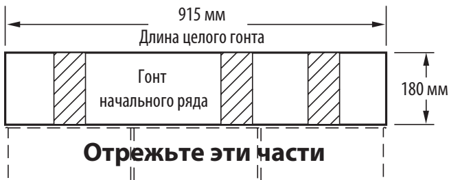
Рис. 13-8. Изготовьте гонты начального ряда, отрезав 5-дюймовые язычки.
