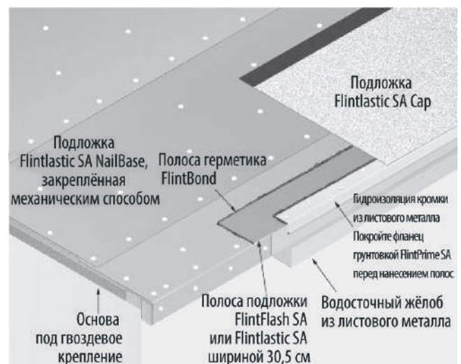
Рис. 5-30. Конструктивные особенности водосточного жёлоба в двухслойной системе.
