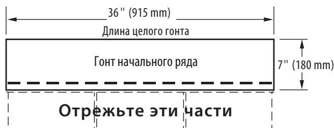
Рис. 10-6. Изготовьте гонты начального ряда, отрезав язычки.
