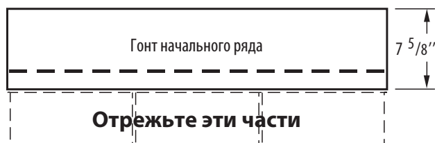
Рис. 12-6. Высота гонтов должна составлять не менее 194 мм.
