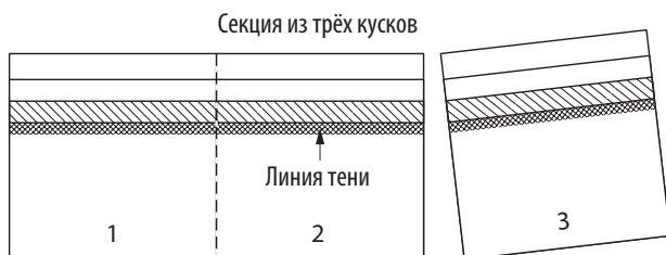
Рис. 12-18. Разделите, чтобы получить 3 покрывающих гонта.
