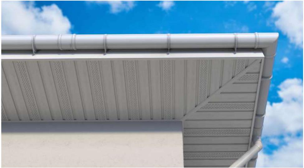
При классическом и самом эффективном методе вентиляции подкровельного пространства приток воздуха осуществляется через нижнюю часть ската – карнизный свес. Для достаточной вентиляции кровли приток воздуха должен осуществляться равномерно по всей длине карнизного свеса.
