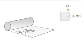
Усилие, прикладываемое в продольном и поперечном направлении для определения максимальной нагрузки в H/50 мм.
