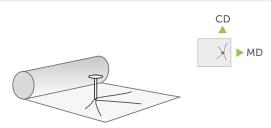
Сила, прикладываемая в продольном и поперечном направлении, при вбитом гвозде, для определения максимальной нагрузки в Н (Ньютон).
