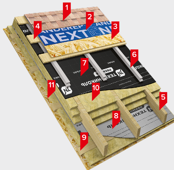
КОНСТРУКЦИЯ СОВМЕЩЕННОГО ЧЕРДАКА (МАНСАРДЫ)
