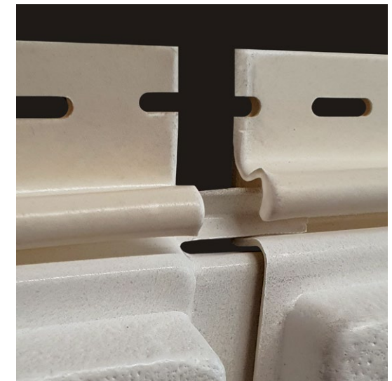
Рис. 16 Усиление жёсткости вертикального соединения панелей (необходимо выполнять при отдалении стойки обрешётки на расстоянии более 100 мм)
