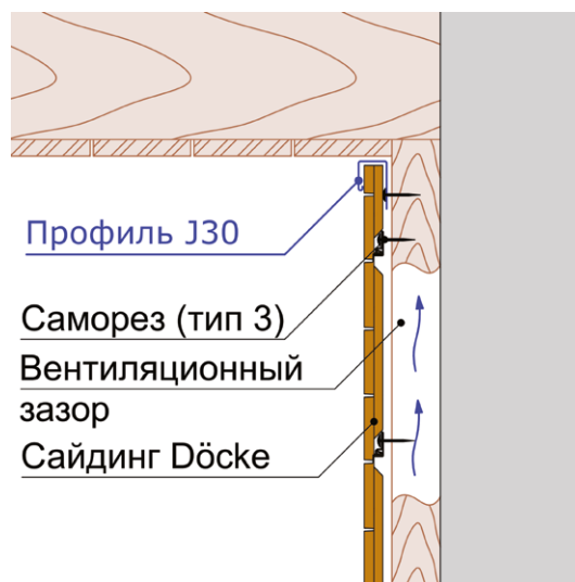
Рис. 20 Примыкание сайдинга Döcke LUX под камень к горизонтальной поверхности.
