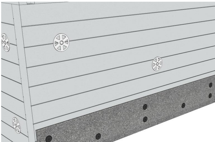
Монтаж стартовой полосы
