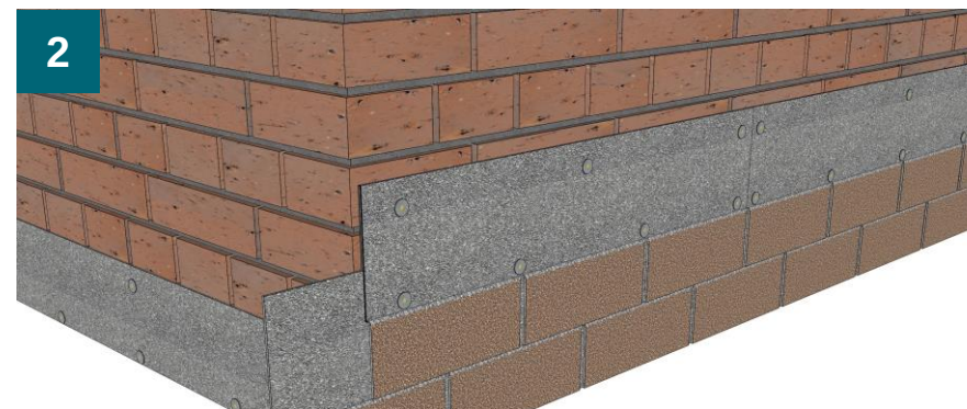
Монтаж рядовой плитки (5 гвоздей на плитку)
