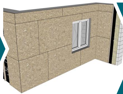
Монтаж сплошного основания
